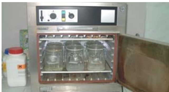
Figure 1 : Appareillage pour la détermination des isothermes de sorption
