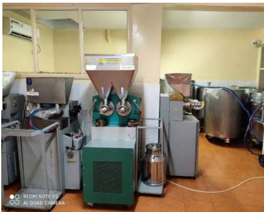
Figure 3: Extraction mécanique de l'huile d'argane. ( Fasskaoui et al., 2022 ).
