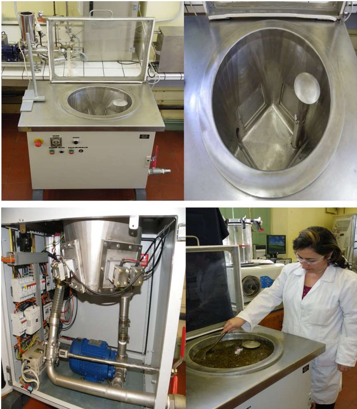
Figure 20: Procédé ultrasonique (30 L) utilisé pour l'enrichissement assisté par ultrasons (Achat et al. , 2012).
